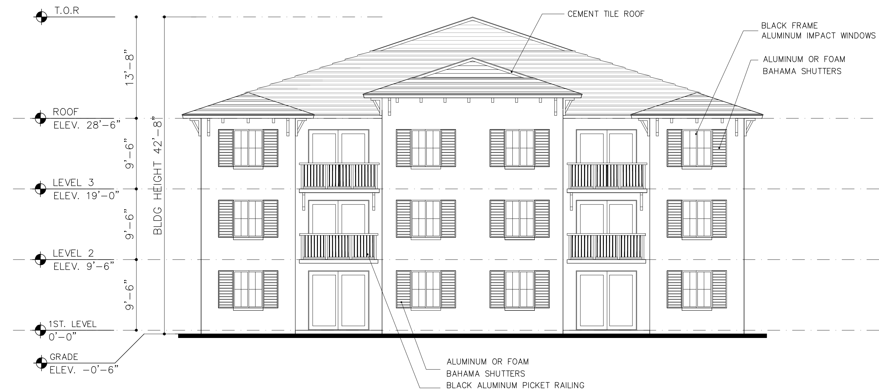
2 SIDE ELEVATION SCALE: 1/8"=1'-0"
